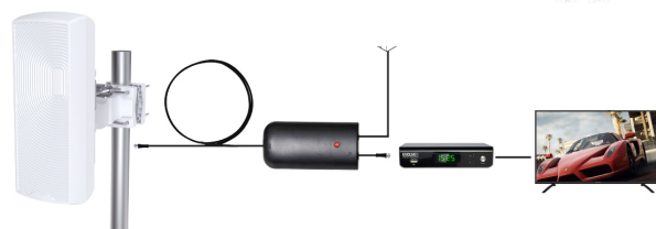
Instalace 2: Připojené pomocí set-top boxu (Obr.7)
