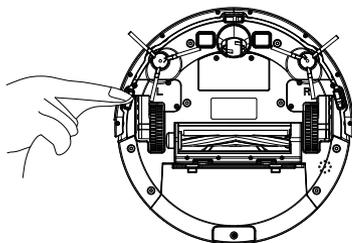
Reinigen Sie die Rollen und das Mittelrad
