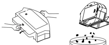
3. Entfernen Sie den Schaumfilter und den Hauptfeinfilter
