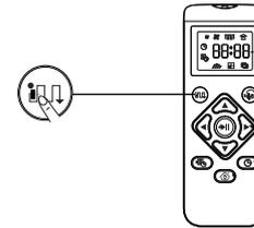
• Passen Sie die Saugkraft an, um eine möglichst effiziente Reinigung zu gewährleisten.
