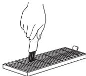
5. Verwenden Sie zum Reinigen des Hauptfeinfilters Wasser
