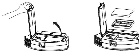
4. Reinigen Sie den Staubbehälter und die Filter mit einem Saugroboter oder einer Reinigungsbürste.
