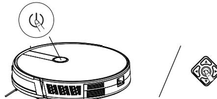
**Ausschalten:** Halten Sie die Taste
