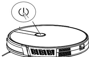
2. Um den Saugroboter vollständig anzuhalten, drücken Sie die Taste
