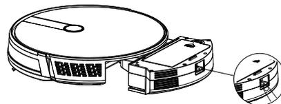
2. Öffnen und leeren Sie den Staubbehälter
