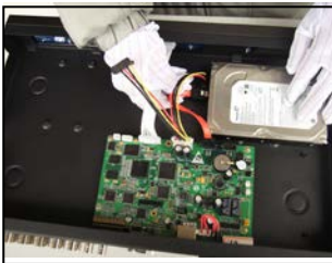
4. Csatlakoztassa a SATA adat kábelt a merevlemezhez
