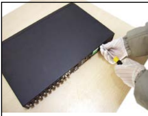
1. Távolítsa el a csavarokat a készülék házából
