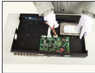
5. Csatlakoztassa a SATA tápkábelt
